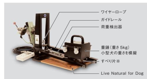
フロア上にペット(犬)を想定したすべり片付きの重錘を置き、斜め上18°の方向に所定の荷重速度で引っ張ります。その際の引張荷重を荷重検出器で測定し、すべり片が動き出すまでの荷重の最大値を求め、次式にしたがってすべり抵抗係数「C.S.R・D」を算出します。
