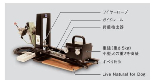
フロア上にペット(犬)を想定したすべり片付きの重錘を置き、斜め上18°の方向に所定の荷重速度で引っ張ります。その際の引張荷重を荷重検出器で測定し、すべり片が動き出すまでの荷重の最大値を求め、次式にしたがってすべり抵抗係数「C.S.R・D」を算出します。
